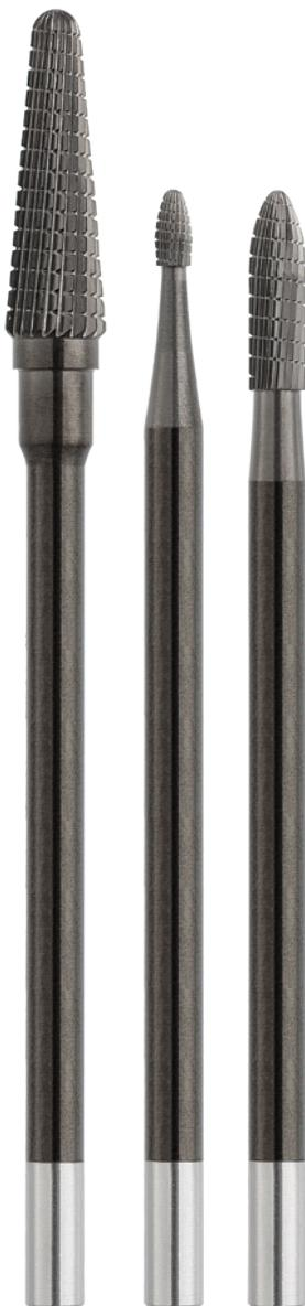
Provvisti di un rivestimento nero, questi fresoni per laboratorio D+Z sono stati specificamente realizzati per la lavorazione di leghe metalliche non preziose difficili da trattare. Il taglio a dentatura trasversale non solo divide le lame in segmenti più piccoli, ma facilita, inoltre, la penetrazione degli strumenti nel materiale duro.
